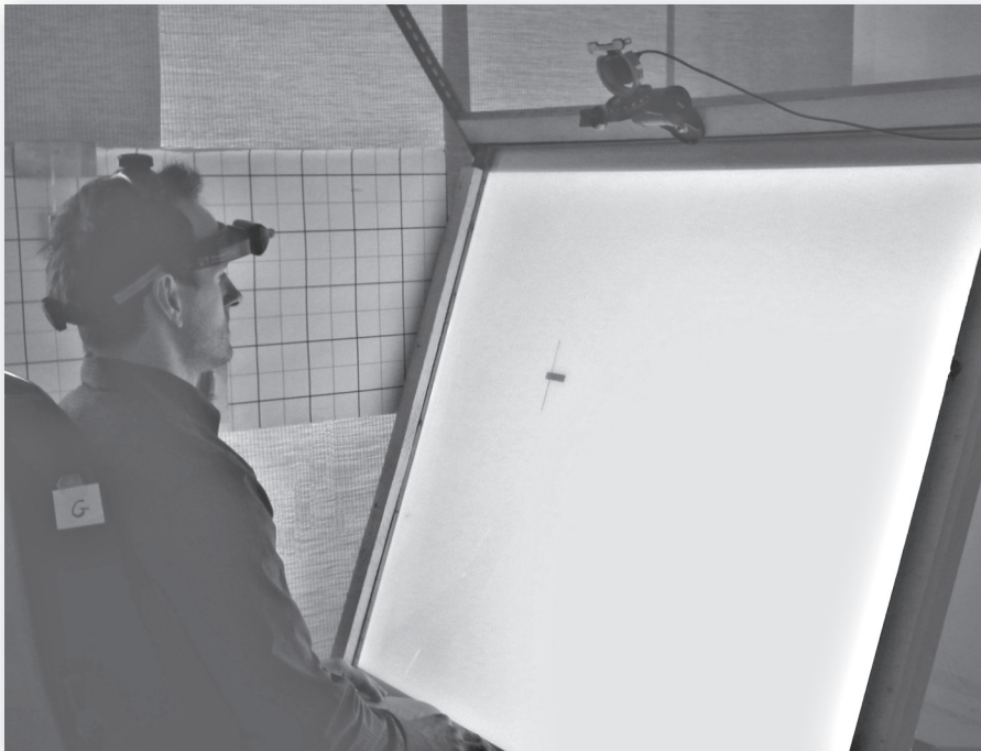
Bild 2: Versuchsperson beim Tracking: Auf einer Rückprojektionswand ist der Cursor (vertikaler Strich) durch Kopfbewegungen auf dem Zielobjekt (horizontaler Balken) zu führen. Dazu dient ein Kopfmaussystem mit einer Kamera oberhalb der Projektionswand
